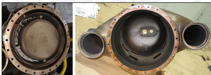
Figura 60 - Escudo, estatoras e "case" da câmara de combustão.
